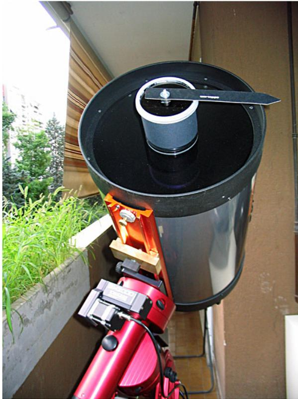
***L'immagine che segue è l'apparenza della stella comatica per la scollimazione: ruotando l'astina sul fronte dello strumento sino a che l'immagine della stessa corrisponde, sovrapponendosi a quella della stella, alla direzione di scollimazione ci dirà quale è la vite o la coppia di viti sulle quali operare. In tal modo la procedura di collimazione diviene facile ed immediata.***
