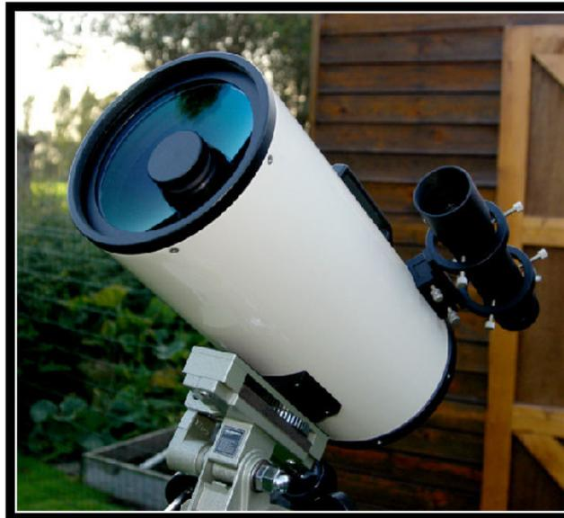
***Una sottocategoria dei telescopi Matsukov sono i cd "Matsukov-Newton", in pratica telescopi Newton con un menisco anteriore che corregge le aberrazioni residue e con uno specchio secondario molto piccolo. Tale tipo di telescopi, sviluppato da alcuni produttori russi, ha avuto, grazie alla notevole qualità ottica, una diffusione notevole come strumenti planetari e di osservazione ad elevati ingrandimenti.***
