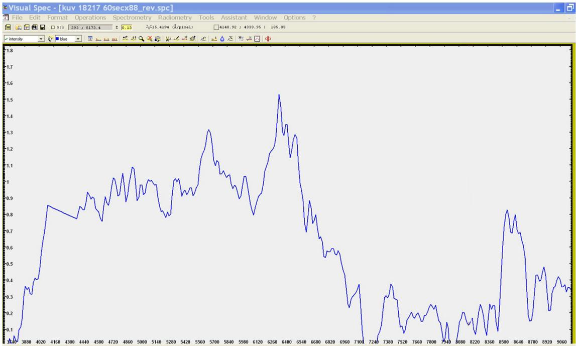
Il profilo spettrale calibrato in lunghezza d'onda
