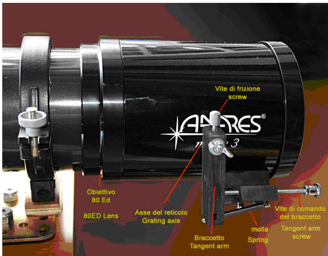
Il sistema di regolazione veloce e micrometrica dell'inclinazione del reticolo e dell'esplorazione dello spettro
