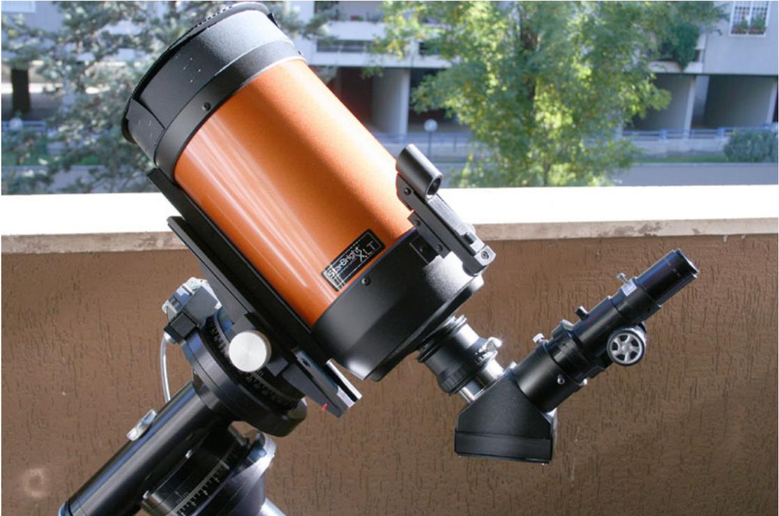
Uno spettroscopio DADOS con camere di guida e ripresa ed un flip mirror al fuoco di Uno SC commerciale (foto Richard Walker): il treno ottico è notevole ed il punto debole della struttura è tra lo spettroscopio stesso e l'attacco posteriore del telescopio; occorrerebbe quindi sincerarsi che sia il flip mirror che l'adattatore da 2 pollici siano sufficientemente robusti e privi di giochi.
