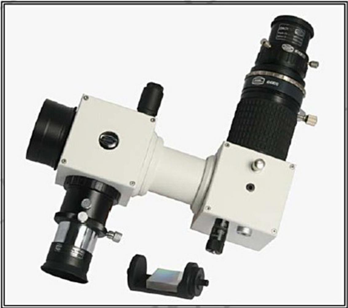
Dallo schema dello strumento si osserva che la luce in arrivo dal telescopio sulla fenditura viene parzialmente deviata da un prisma verso un portaoculare dove può essere alloggiato un oculare per la centratura dell'oggetto sulla fenditura stessa e l'eventuale camera di guida. Il collimatore, foccheggiato sulla fenditura riflettente, invia il fascio ottico al reticolo, dal quale l'immagine spettrale diffratta viene poi inviata all'ottica della camera .
