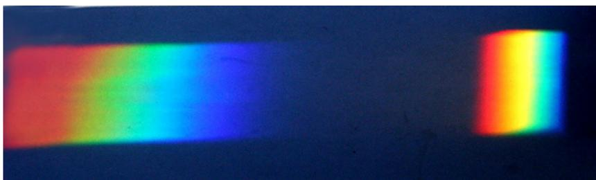
Confronto tra la dispersione di un prisma e quella di un reticolo : come si osserva, l'intensità luminosa del prisma è di gran lunga maggiore di quella del reticolo in quanto la luce diffratta non viene "diluita" negli ordini, ma la dispersione è nettamente inferiore a quella di un reticolo di basso potere (300 l/mm) nell'esempio mostrato.
