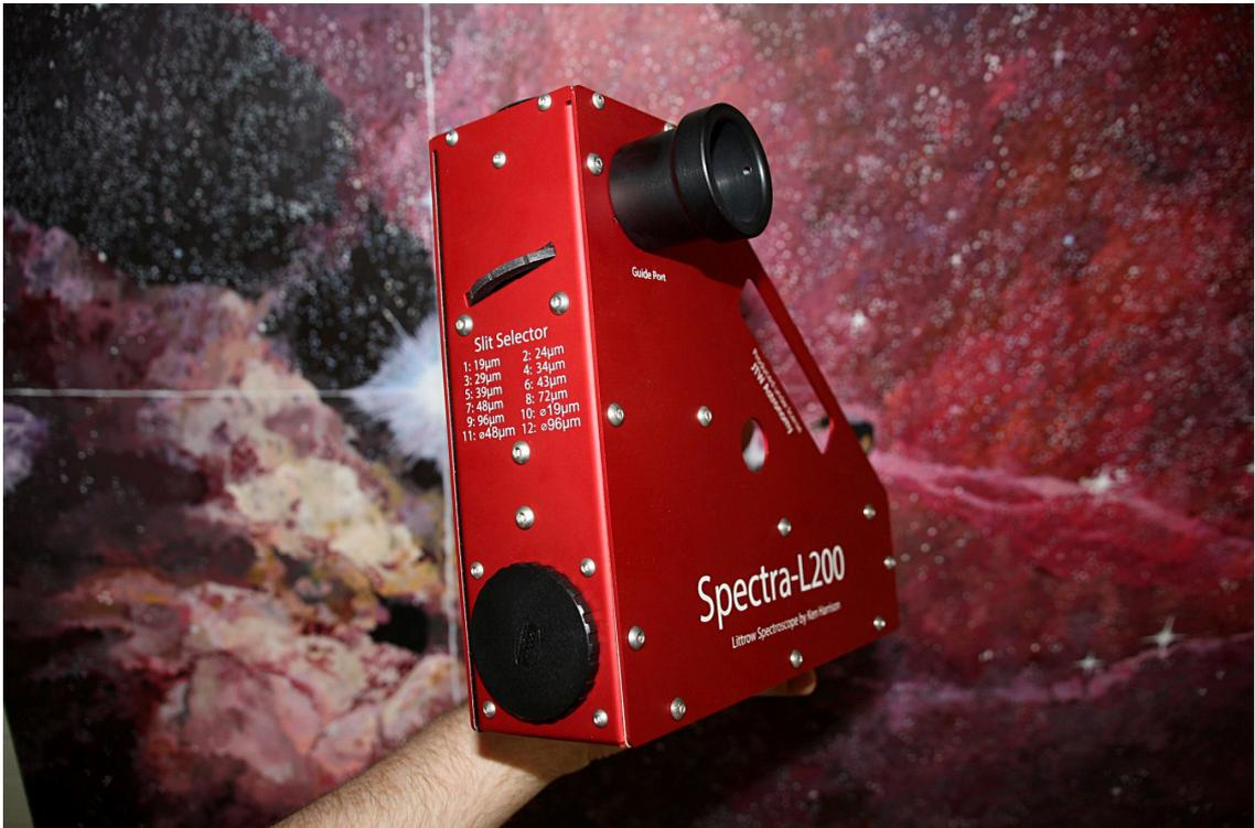
Lo strumento è offerto in due versioni, base, con un reticolo da 600 l/mm a 1369 € e de luxe, con 3 reticoli a scelta ed una lampada di calibrazione al neon a 1749 €.
