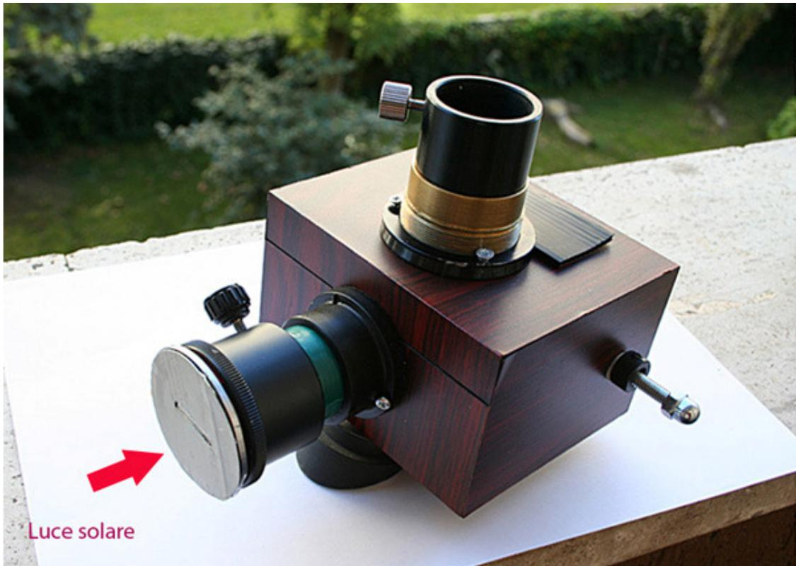
Il suo uso visuale appare sufficientemente appagante, dato che permette, muovendo leggerissimamente l'asse del reticolo, di osservare le più importanti righe dello spettro solare.
