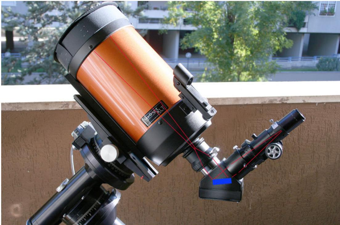
Tali sistemi non possono entrare in concorrenza con quelli a fenditura per l'ovvia perdita di risoluzione nei confronti di quest'ultima e per la loro dipendenza dal seeing. Tuttavia per alcune applicazioni risultano utili e di estrema facilità di utilizzo per un neofita e suscettibili di dare output notevoli.
