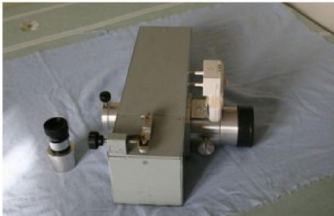
Schema di spettroscopio a prisma di Littrow autocollimante del compianto grande astrofilo ed auto costruttore Ing. Vittorio Lovato.
