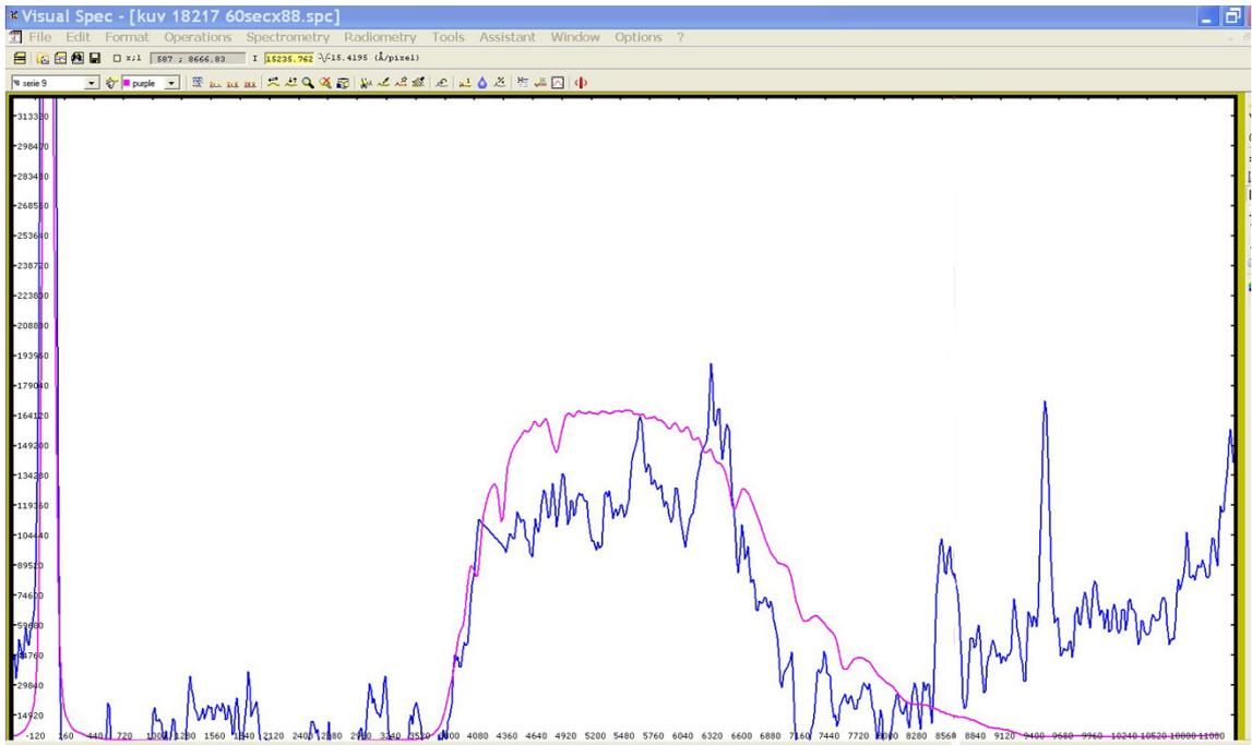
Il profilo spettrale sovrapposto a quello della stella Vega, ripresa nella stessa sera, per la calibrazione in lunghezza d'onda.
