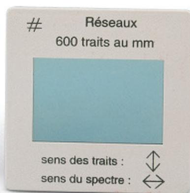
Reticolo in acetato da 600 l/mm su telaietto di diapositive, e quindi di formato 24 x 36 mm. Tali reticoli, pur di qualità modesta per il supporto, hanno il vantaggio che lo spessore molto ridotto di questo consente anche l'uso di un potere da 1000 l/mm.
