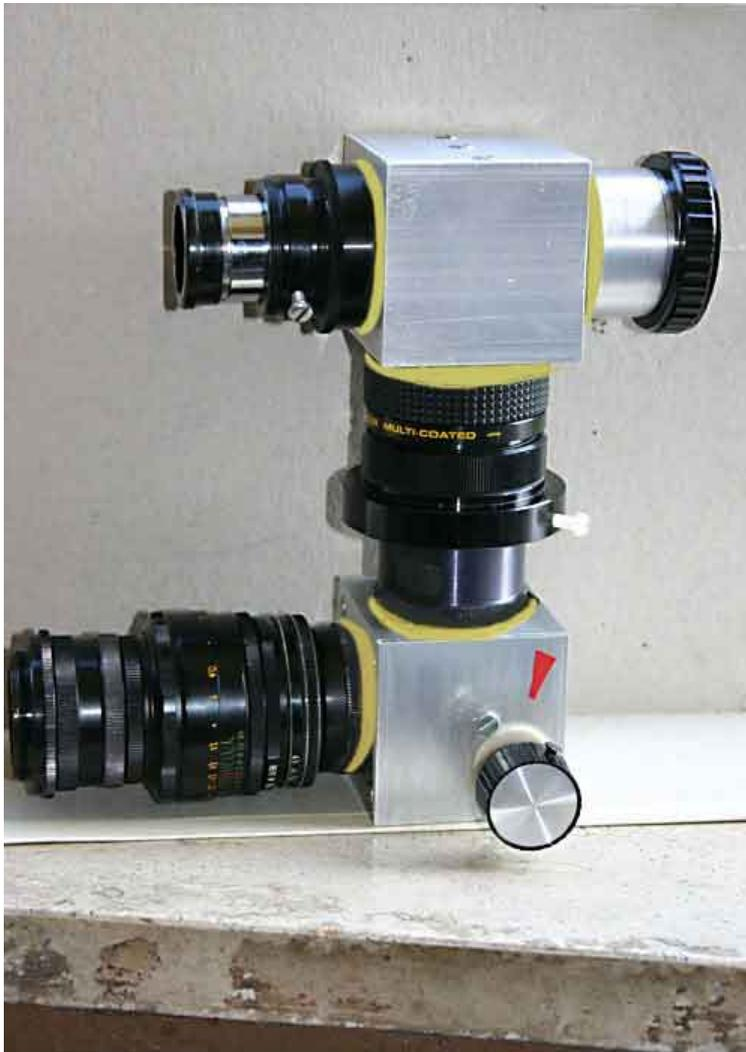
Gli attacchi indicati in giallo sono filettati 42x1, in modo da rendere il sistema completamente e facilmente aggiornabile sia per quanto riguarda le ottiche che il beam splitter ed il reticolo. L'ottica della camera, attualmente un 58 mm, potrà essere cambiata, ove necessario, con un 135 mm a vite, od alla stessa potrà essere aggiunto un duplicatore di focale per aumentare la risoluzione.
