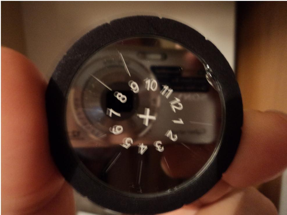
Fenditura specchiata usata sullo spettroscopio commerciale L200 (cortesia JTW Astronomy)
