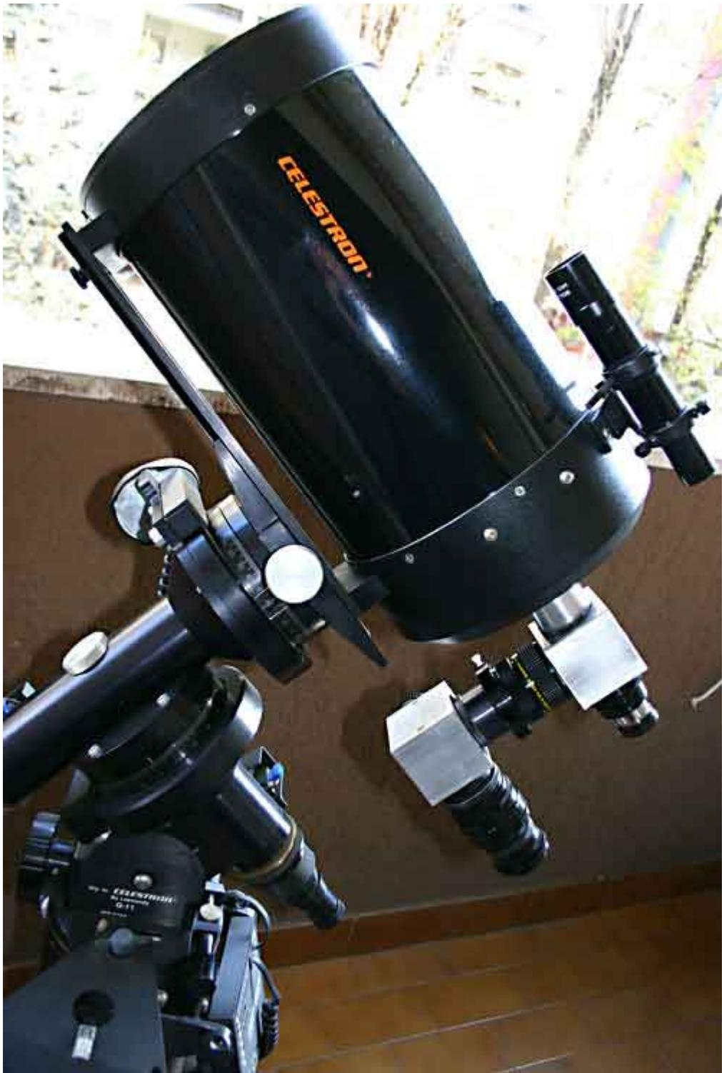
Per capire il livello di prestazioni fornito dallo strumento vale la seguente immagine, che mostra lo spettro di Capella, Alfa dell'Auriga, classe G0, ripreso con CLAUS , un C11, ed una camera Atik 16 HR con sensore Sony ICX 285 AL con pixel da 6,45
