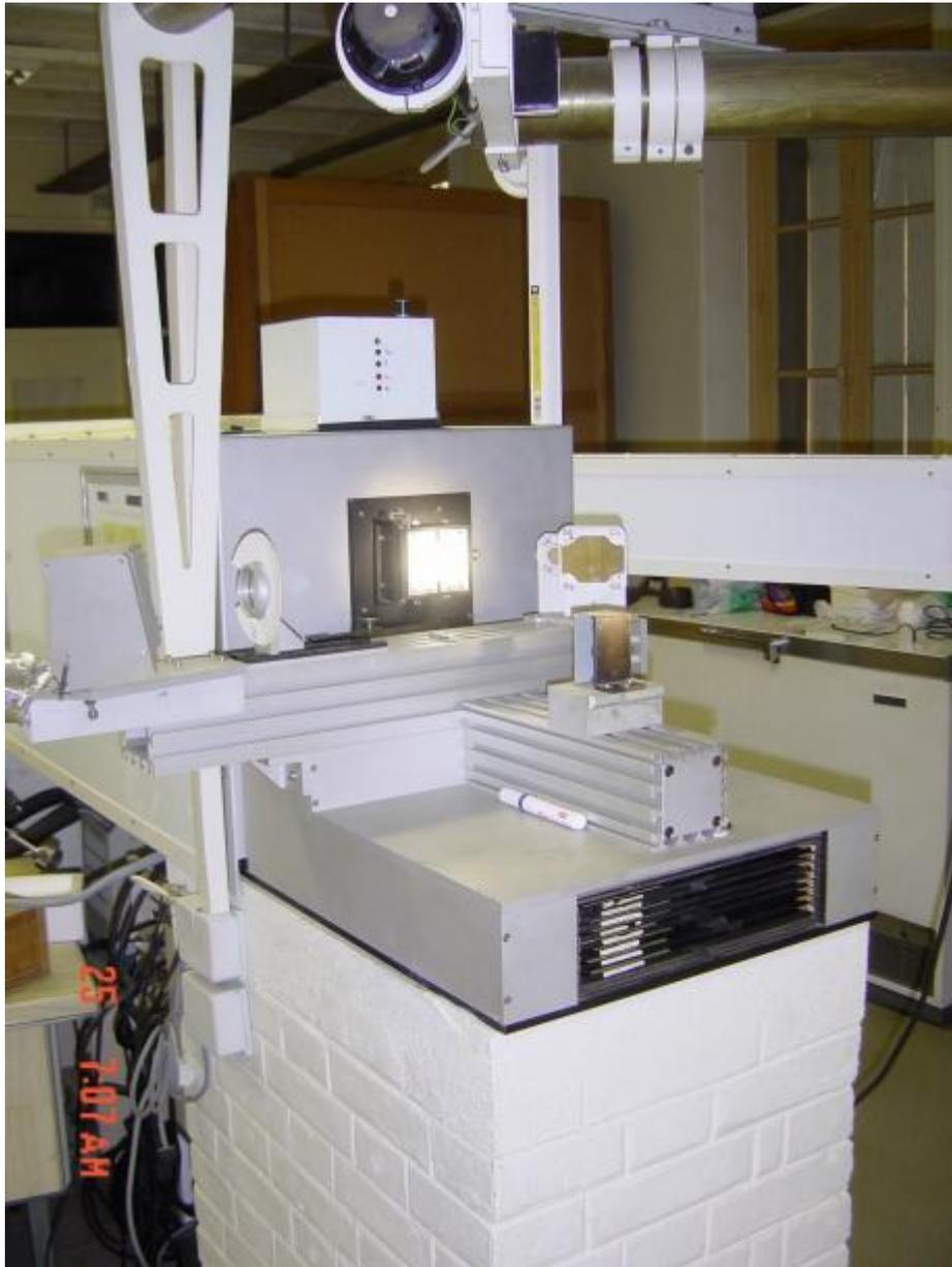
Lo spettrografo nella sala di controllo. Questo fornisce una dispersione di 3.33 Å/mm nel 3° ordine in H $\alpha$ , equivalente a circa 0.03 Å/pixel con una camera con pixels da 10 micron e 0.016 con una camera con pixel da 5 micron.
