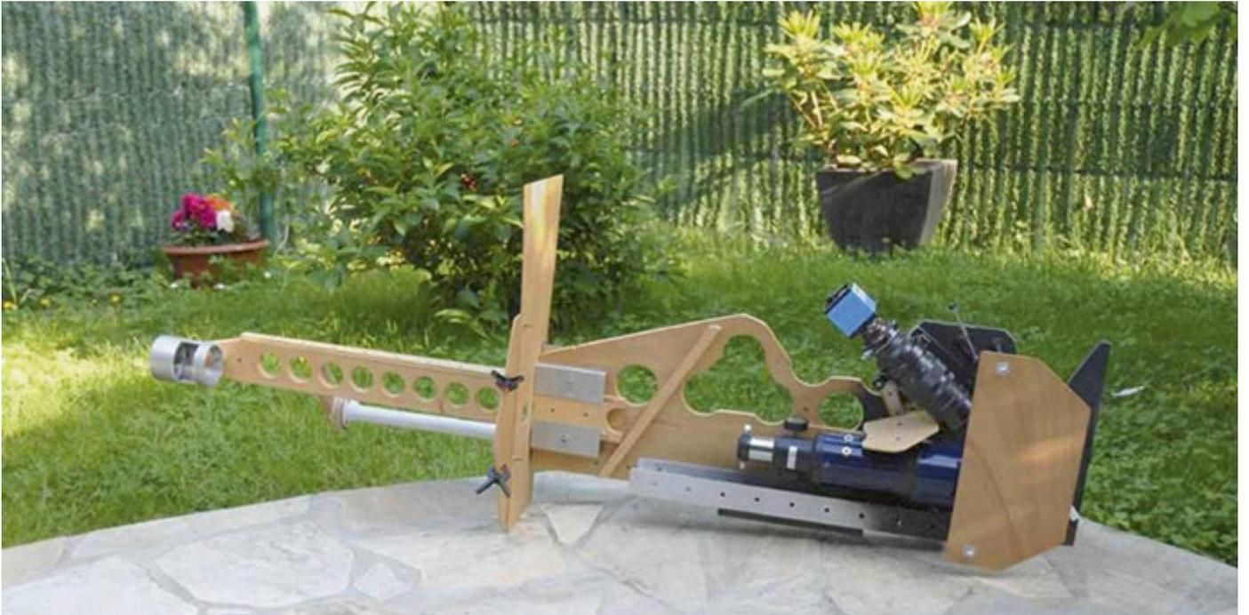
Nell'immagine soprastante uno spettroscopio in versione classica che compone il modello di spettroeliografo usato dal francese Daniel Deforneau, cui va ascritto il merito, insieme a Rondi, di aver introdotto il principio della spettroeliografia digitale all'inizio degli anni 2000, realizzando anche un apposito programma informatico per l'estrazione delle immagini solari dallo spettro.
