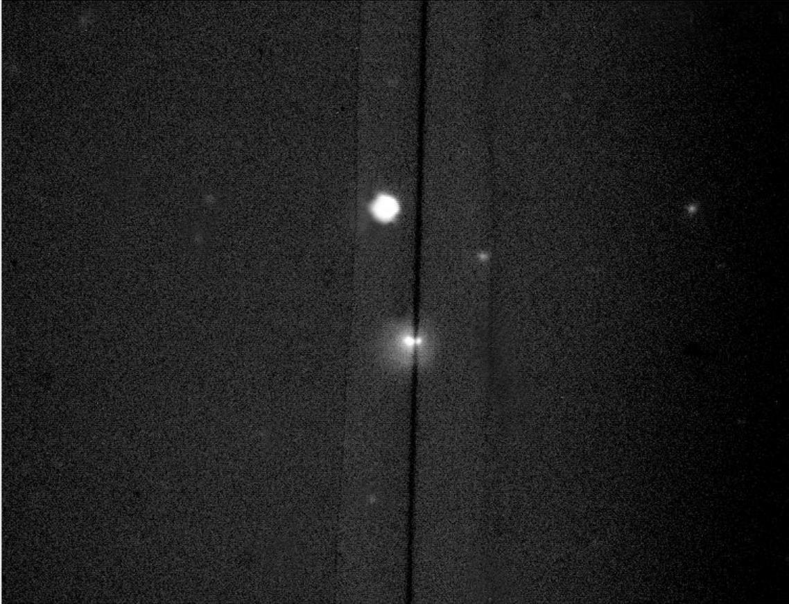
La fenditura, di 25 micron, come mostra l'immagine della camera di guida S Xpress Lodestar, era posta lungo l'asse della nebulosa passando per la condensazione e la stella centrale.
